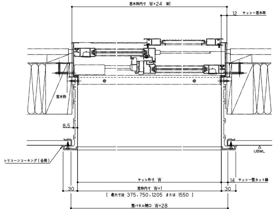
※1 窓枠外周の木枠寸法です。サッシが納まる部分の木枠寸法はサッシ形状により異なります。
