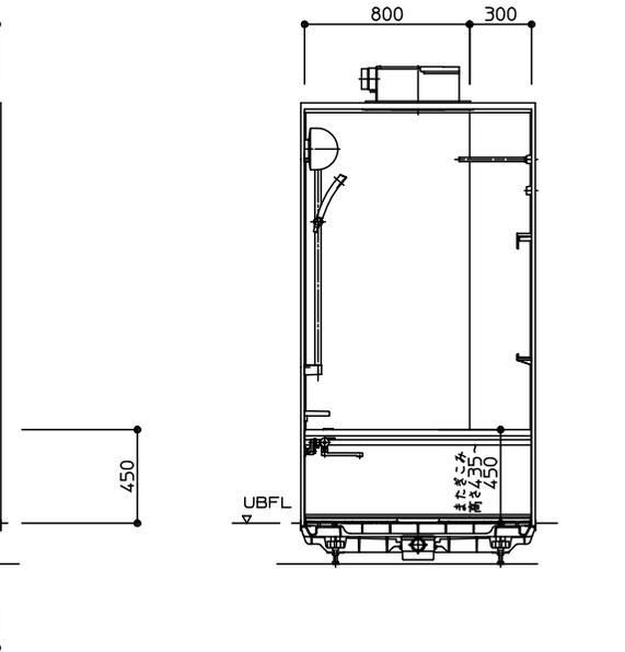
\*UB据付高さ調整範囲 213~253mm
